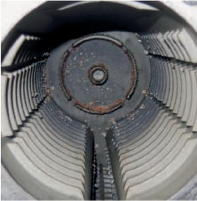
**Abb. 3: Brennwertkammer des Öl-Brennwertkessels WTC-OB nach einer Laufzeit von ca. 5000 Betriebsstunden mit GtL.**
