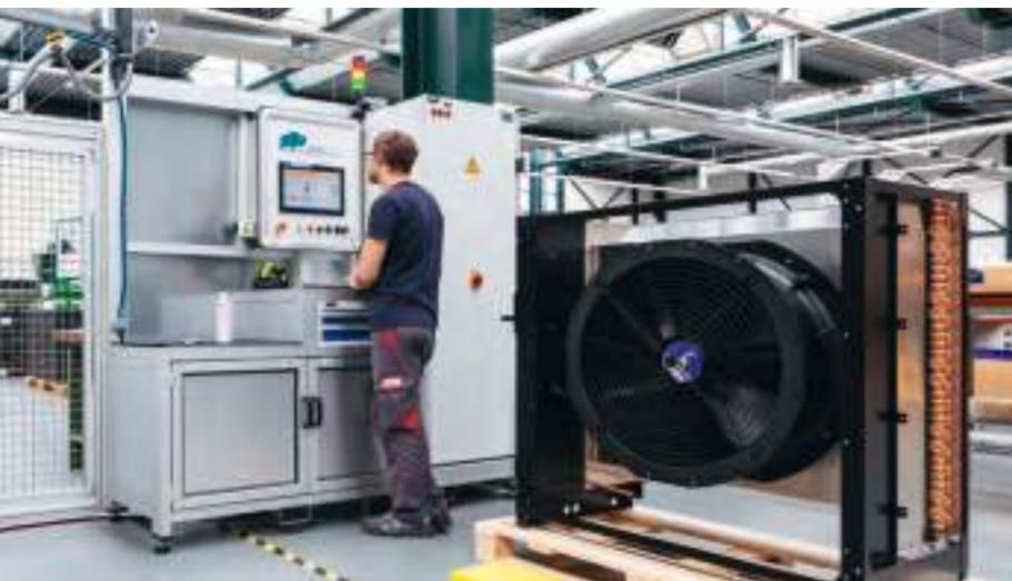
**Funktionstests** bei der Wärmepumpe Biblock.
