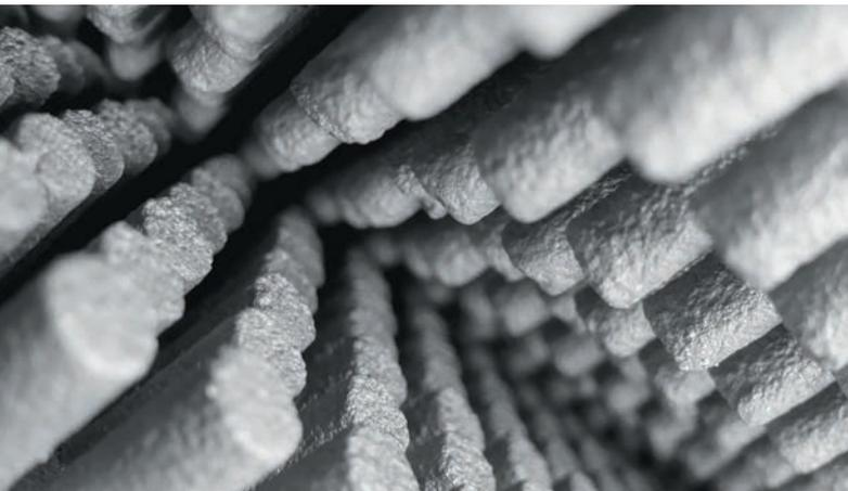
*Aluminium-Silizium-Sandguss leitet die Wärme optimal weiter und ist äusserst widerstandsfähig und langlebig.*
