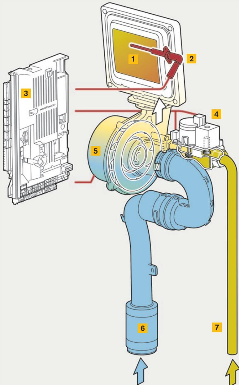
Die Weishaupt SCOT-Elektrode misst ein Flammensignal, das der Condensmanager in den  $O_2$ -Gehalt im Abgas umrechnen kann – entsprechend wird der Brenner geregelt.
