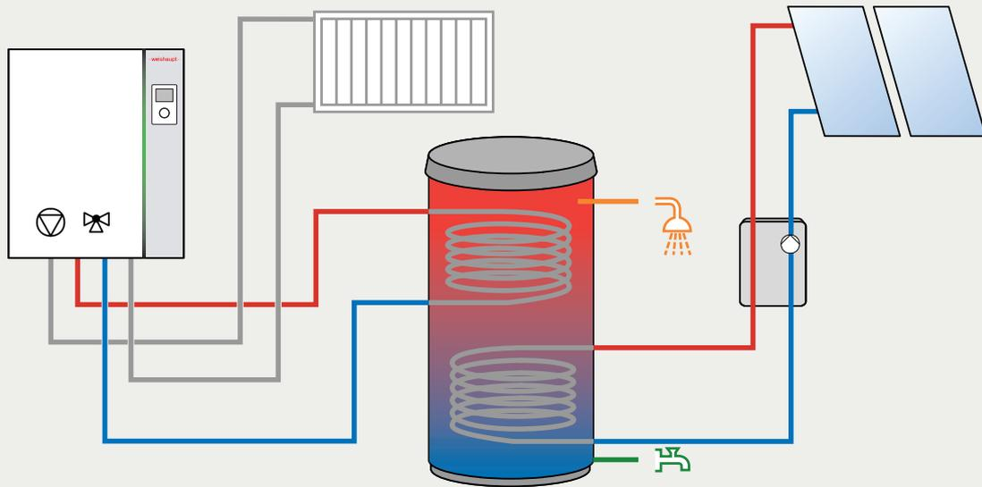
**Gas-Brennwert mit Solaranlage zur Trinkwassererwärmung mit WAS Sol-Eco**
