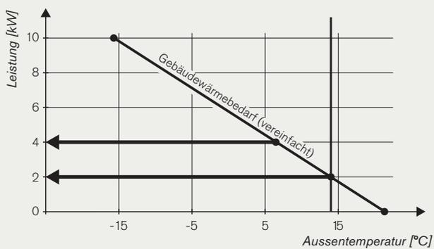
Durch den grossen Modulationsbereich kann die Jahreslaufleistung deutlich gesteigert werden. Dadurch werden Brennerstarts auf ein Minimum reduziert.
