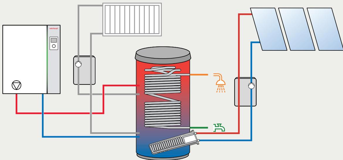
**Gas-Hybrid mit Solar zur kombinierten Trinkwassererwärmung und Heizungsunterstützung mit WES-A**
