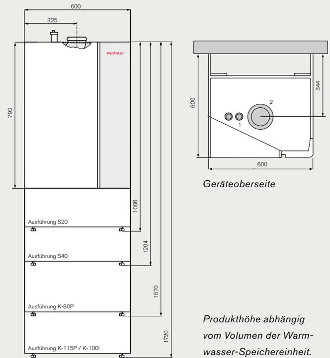
*Produkthöhe abhängig vom Volumen der Warmwasser-Speichereinheit.*
