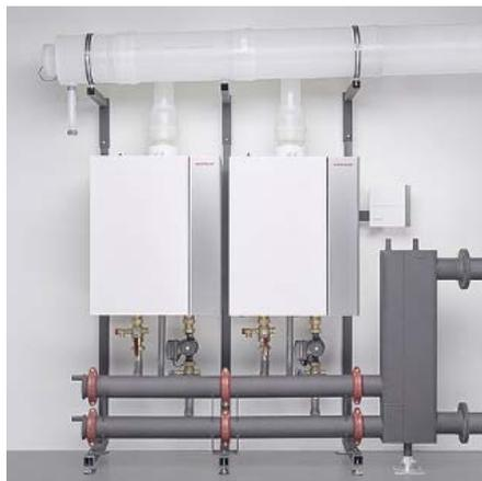
Gasbrennwertgerät WTC-GW 80/100-A Kaskaden mit bis zu acht Geräten (800 kW) sind möglich.
