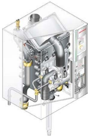
Das neue Gas-Brennwertgerät Thermo Condens WTC-GW 80/100-A im Schnitt.
